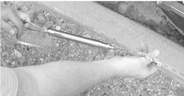
Figura 21: Usando la herramienta tensora de cinta (báscula para pescado)
