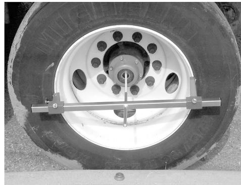
Figura 19: Extensión de terminal de rueda instalada
