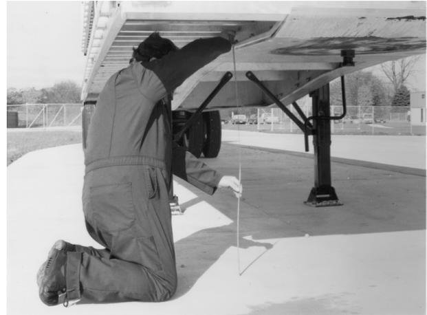
Figura 15: Midiendo la altura actual del perno rey
