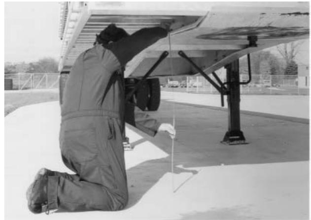
Figura 2. Medición de la altura del perno rey
