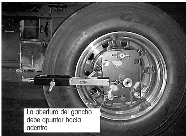
Figura 12. Sujutando el extensómetro a las extensiones de la terminal de la rueda
