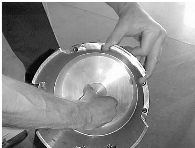
Figura 17. Verificando que el vástago este apretado
