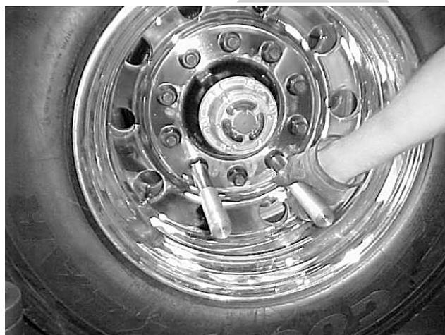
Figura 6. Instalando las extensiones para birlo
