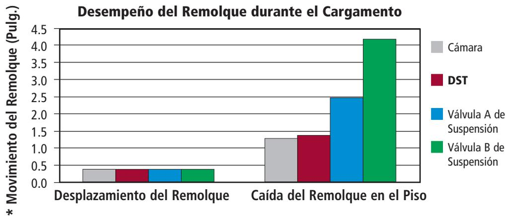
\* Datos recogidos de un remolque típico de caja cerrada durante la carga.
