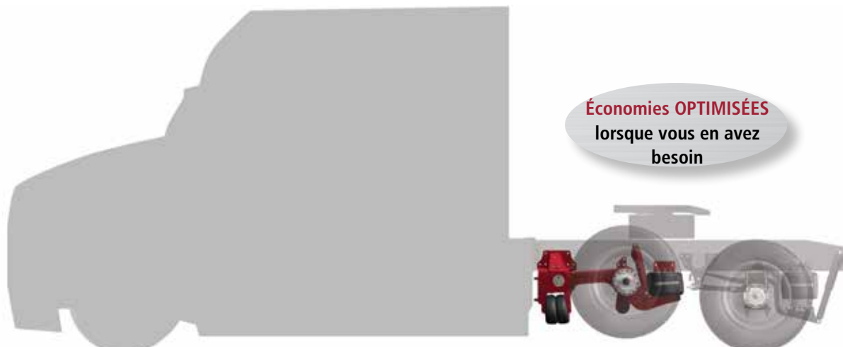
Essieu relevé pour la configuration 4×2 — Le système OPTIMAAX détecte les conditions de charge plus légères et relève l'essieu non moteur
